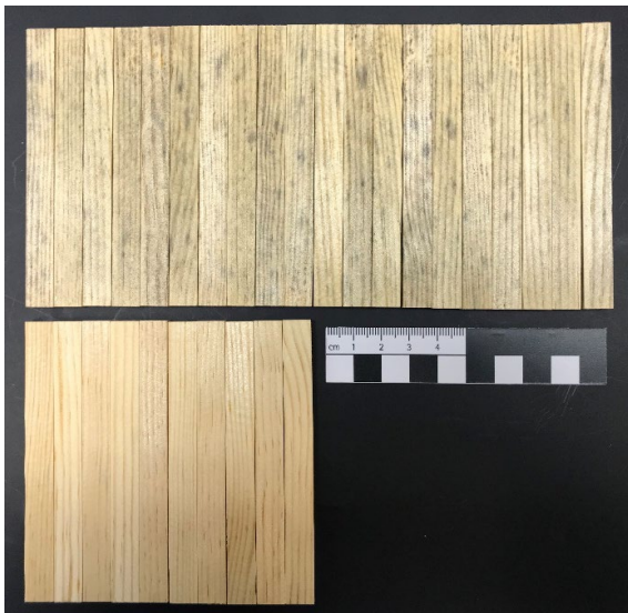
Abb. 1: Kiefernspint-Prüfkörper für Bläuetest und Biegeprüfung
