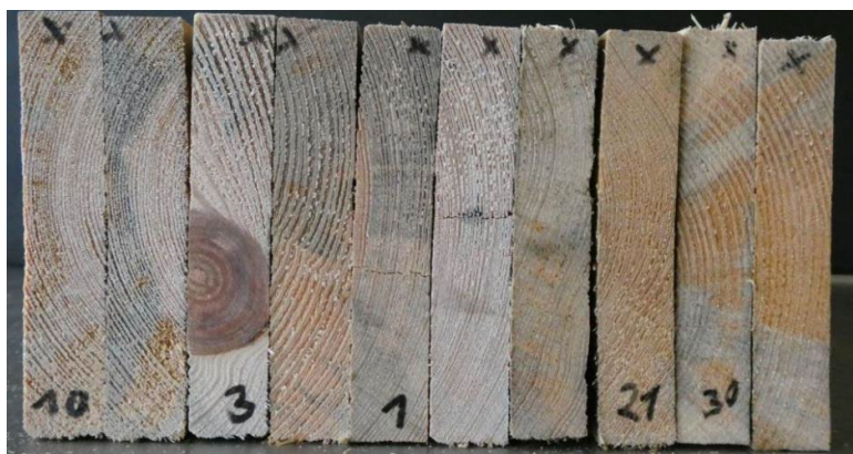
Abb. 5: Repräsentative Bretter im Querschnitt mit Verblauungen
