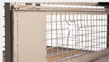
Die Rundstahlgitter sind gerissen, so dass die Drahtenden nach innen oder außen ragen (eine Masche pro Wand darf fehlen).
