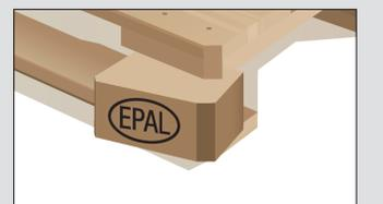
Die EPAL-Kennzeichnung fehlt auf beiden Eckklötzen einer Längsseite.
