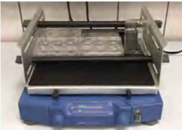
**Abb. 2:** Kreisschüttler mit Prüfansätzen
